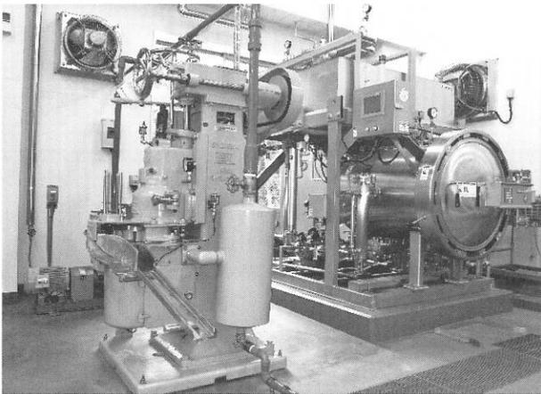
図 2 缶詰巻締機と蒸気釜
